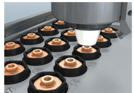
Mit dem Technologiepaket Linse- und Düsenautomatik entfallen alle Tätigkeiten an Linse und Düse.
